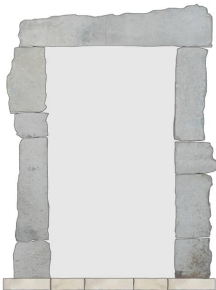
Figura 35 Portale con architrave monolitico. Blocchi all'imposta dell'arco e alla base delle spalle in pietra non decorata, spalle in blocchi di pietra irregolarmente squadrate. Soglia in blocchi di pietra irregolarmente squadrate.
