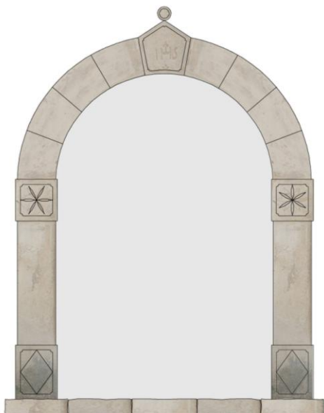
Figura 32 Tipologia 1 - Portale ad arco a tutto sesto in conci di pietra a punta decorato. Blocchi all'imposta dell'arco e alla base delle spalle in pietra decorata. Spalle in blocchi di pietra squadrate. Soglie in blocchi di pietra irregolarmente squadrate
