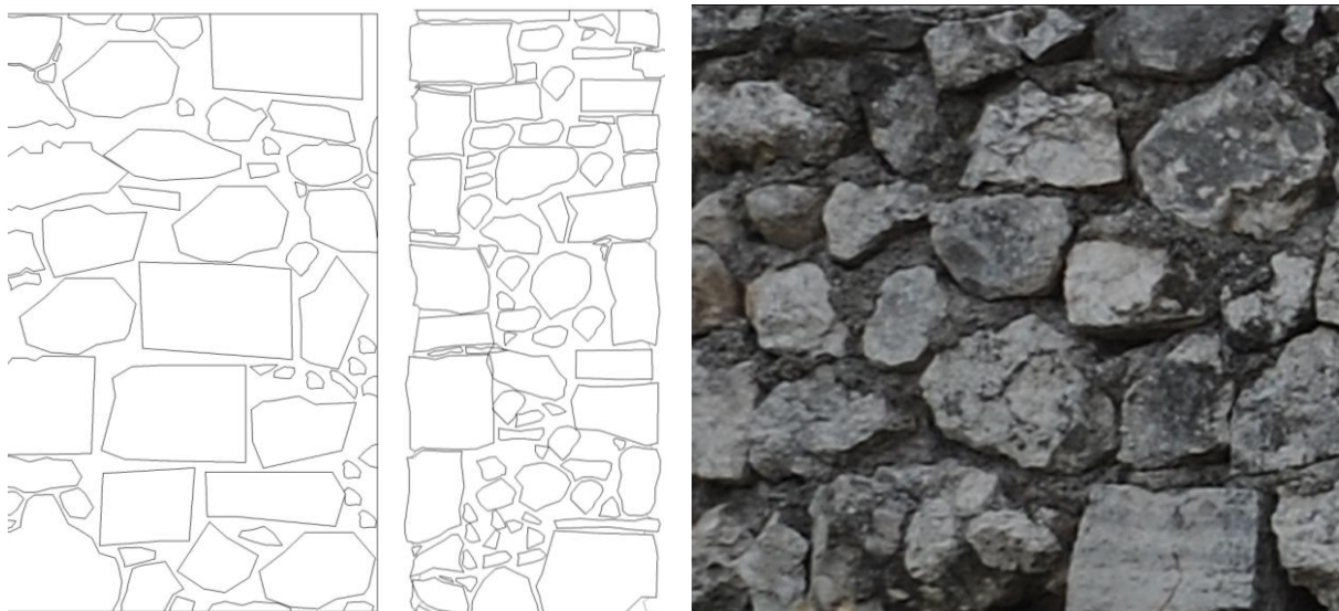
Figura 22 La successione di immagini mostra, da sinistra verso destra, una vista esterna del paramento murario, una sezione longitudinale della muratura, una foto riferita alla tipologia muraria in pietra irregolarmente squadrata rilevata a Navelli, in un aggregato della zona intramuraria.
