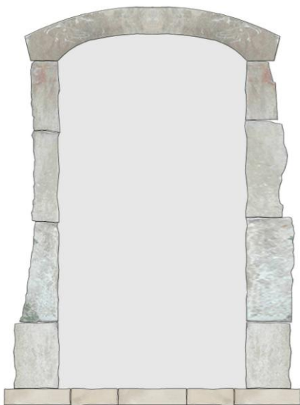
Figura 34 Portale con arco a tutto sesto in conci di pietra grezza con concio centrale a punta e decorato. Blocchi all'imposta dell'arco e alla base delle spalle in pietra decorata, spalle in blocchi di pietra irregolarmente squadrate. Soglia in blocchi di pietra irregolarmente squadrate.
