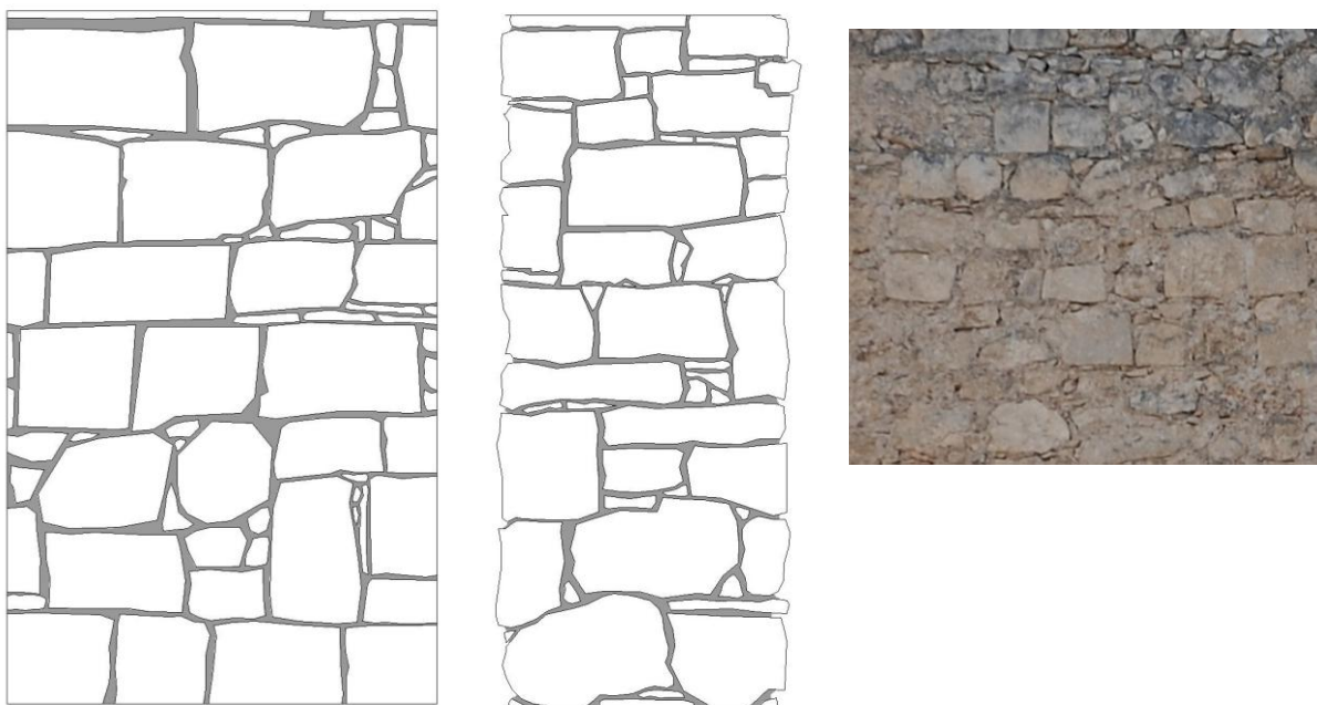
Figura 21 La successione di immagini mostra, da sinistra verso destra, una vista esterna del paramento murario, una sezione longitudinale della muratura, una foto riferita alla tipologia muraria in pietra squadrata rilevata a Navelli, in un aggregato della zona extramuraria
