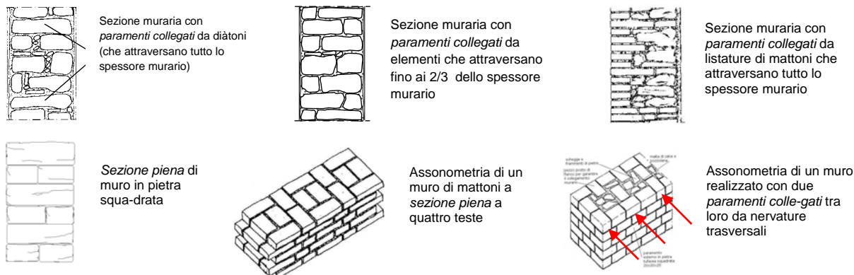
Fig 53 sezione a paramenti ben collegati o ad unico paramento (sezione piena)
